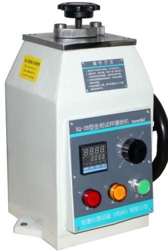
**主要特点:** XQ-2B 型金相试样镶嵌机是对微小或不规则形状和不易手拿的试样,用热固性塑料先进行镶嵌成形,也是磨抛工作必不可少的前道工序。本机械式镶嵌机,加热温度由数字温度仪控制,各种性能稳定可靠,为更安全的操作,本机装有安全防护盖板,是试样镶嵌的最佳设备。
